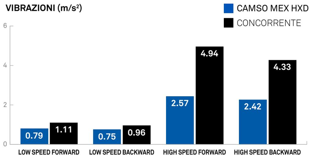
Durante l'intero test, il **livello di vibrazioni dei cingoli Camso è stato del 36% inferiore** rispetto a quelli di qualità OEM, indipendentemente da velocità e direzione.
